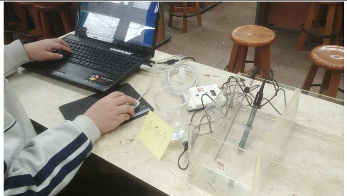
MBL로 굴포천 하수의 온도와 PH를 측정하는 모습
