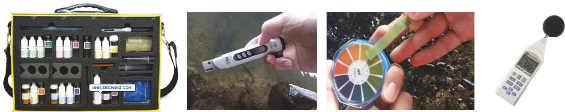
[그림 1] 수질 검사 키트, TDS 및 온도 센서, pH 테스트지, 소음측정기
